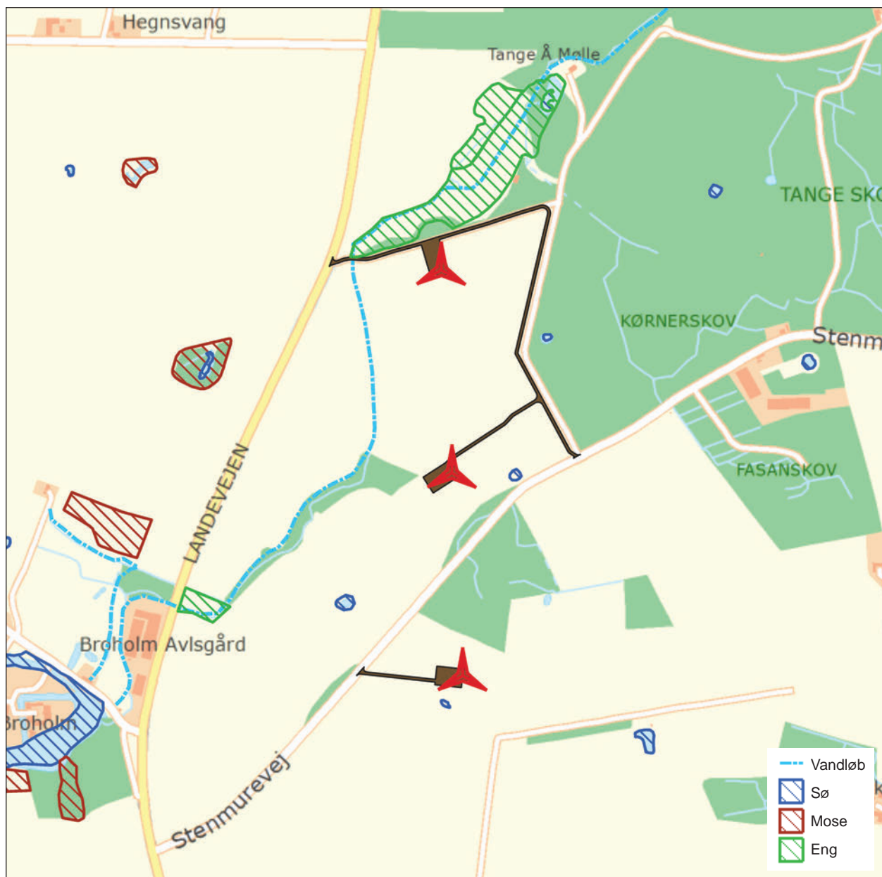
Figur 5.9. Placering af møller, kranpladser og adgangsveje i forhold til beskyttede naturtyper.
